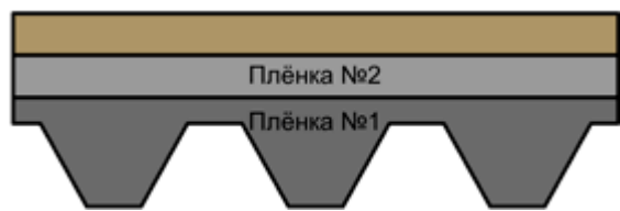
Рис. 18. Тыльная сторона гонта гибкой черепицы Döcke PIE.
